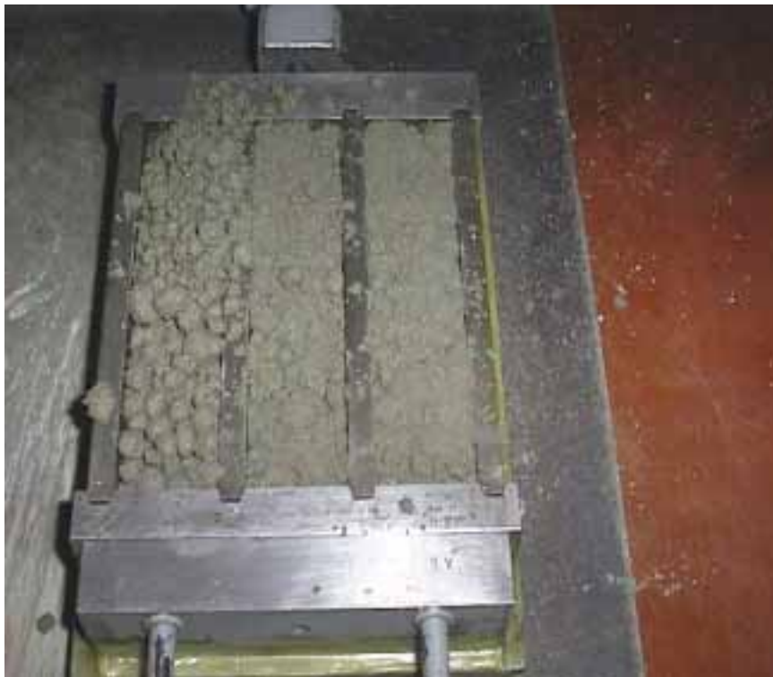
Foto 5 Reparasjonsmørtel med pellets
