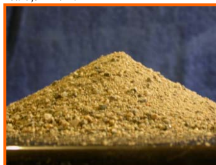
Figur C: Tør tilstand. Opprinnelig kjegle er totalt kollapset og en ny "kjegle" med tydelig spiss er oppstått. Ved stamping reduseres høyden nesten ikke. Materialet i figuren var tørret i 24 timer før prøving
