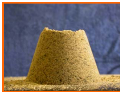
Figur A: Våt tilstand. Tilslaget har samme form som kjeglekonusen. Ved stamping reduseres høyden med ca 2-3 cm
