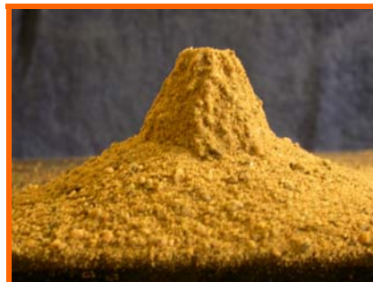
Figur B: Vannmettet overflatetør tilstand (VOT). Kjeglen er like kollapset. Ved stamping reduseres høyden ca 0,5- 1 cm.
